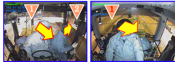
ドライブレコーダ映像による安全確認動作の解析 (注視方向の例)
