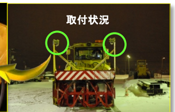
図-4 レーザースキャナ取付状況
