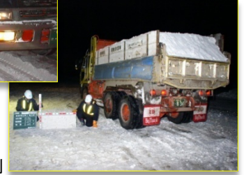
図-2 ダンプトラック荷台雪量計測
