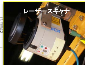
図-4 レーザースキャナ取付状況
