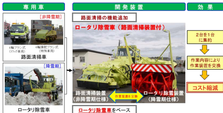
路面清掃車とロータリ除雪車の兼用化
